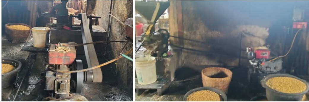
Gambar 2. Mesin penggerak berbahan bakar fosil/solar untuk menggiling kedelai di UMKM industri tahu Sambak.
