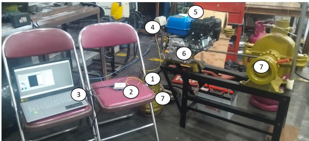
Gambar 5 . Setting data akusisi pada mesin penggerak berbahan bakar gas.
