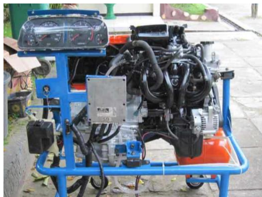
Gambar 1. Simulator EFI ( Electronic fuel injection ) pada engine stand
