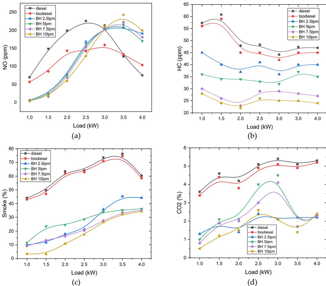
Figure 2. Emissions NO (a), HC (b), Smoke (c), CO<sub>2</sub> (d) on engine load
