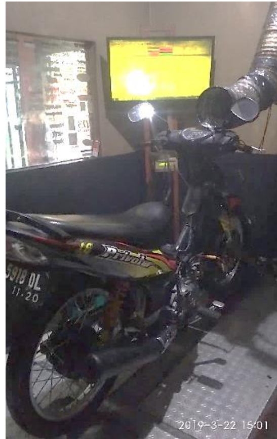
Gambar 6. Photographic view penempatan sepeda motor pada dynamometer
