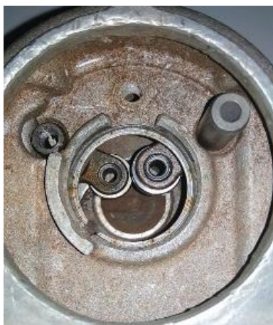
Gambar 5. Pemasangan roller rocker arm untuk menggantikan rocker arm standar
