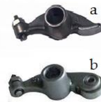
Gambar 3. Perbedaan rocker arm standar (a) dan roller rocker arm (b)
