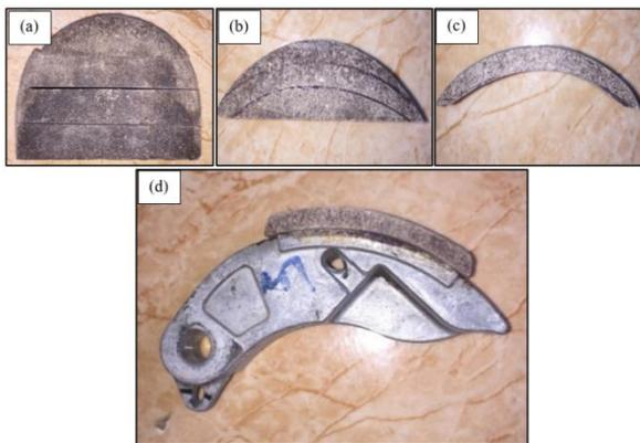
Figure 4. Preparation of specimen: (a-c) cutting process, (d) clutch shoe.
