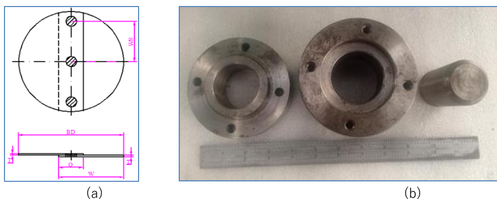
Gambar 3. Geometri blank material (a) dan dies (b).
