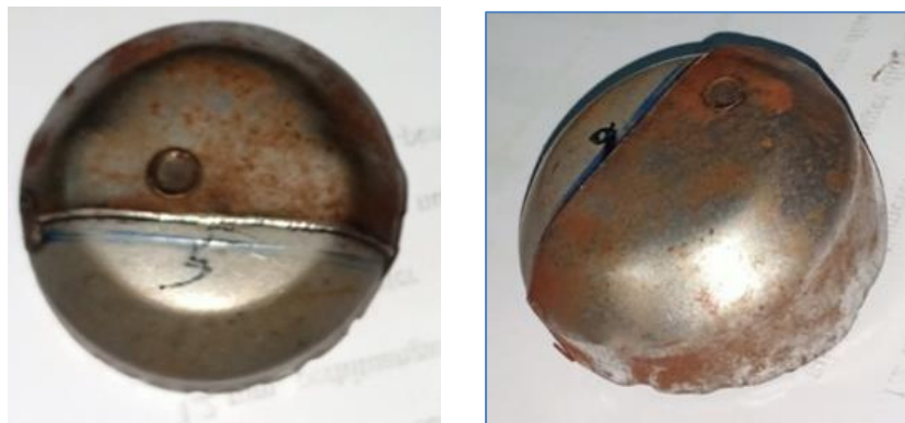
Gambar 6. Hasil uji cup drawing pada specimen no. 5 dan no. 6.
