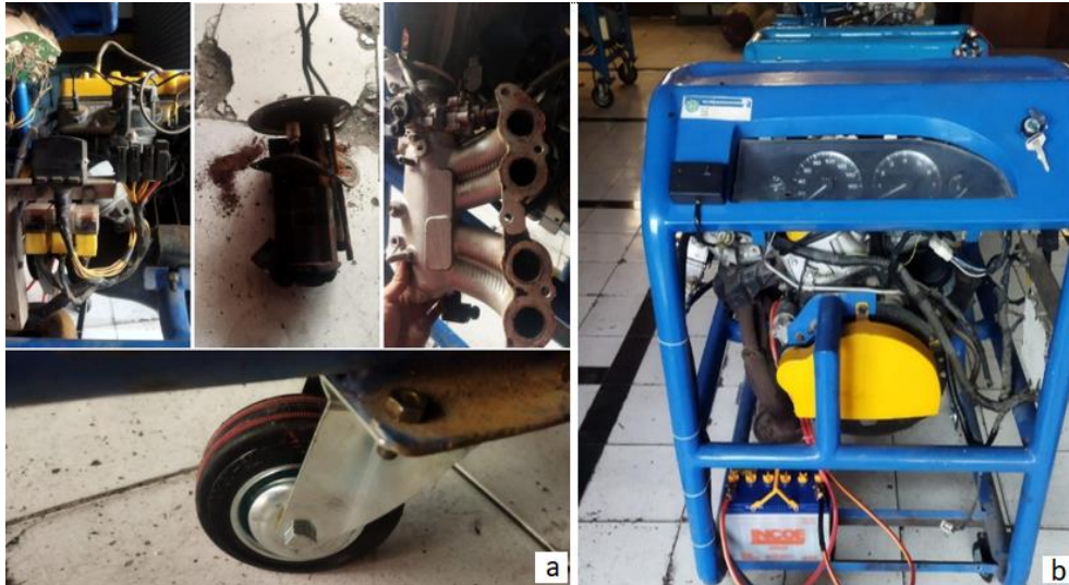
Gambar 4. (a) Proses rebuild mesin dan (b) Mesin yang sudah direbuild
