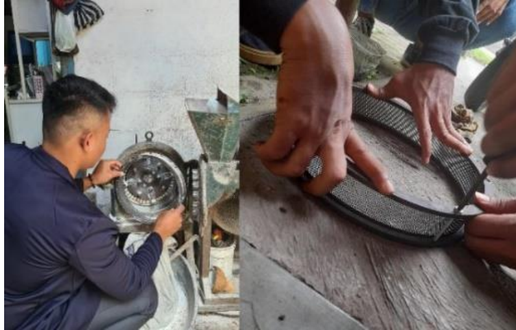
Gambar 9. Proses perbaikan alat penepung beras
