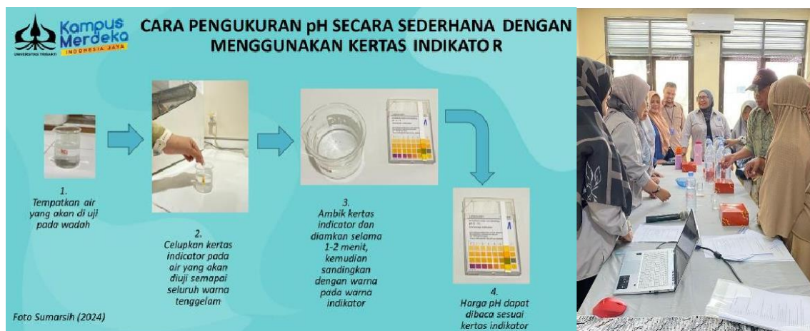
Gambar 4. Langkah-langkah pengukuran pH dengan menggunakan kertas indikator
