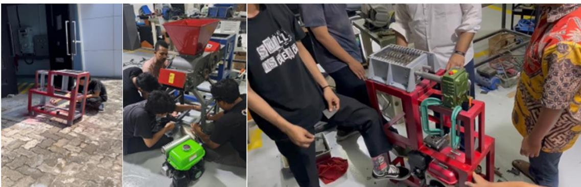
**Gambar 5.** Pengecatan *frame*, perakitan komponen dan pengujian mesin *crumb rubber*
