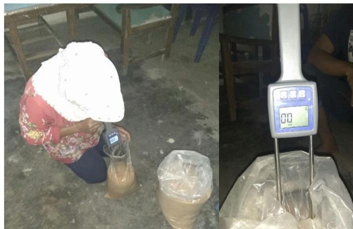
**Gambar 12.** Cara menggunakan alat pengukur kadar air
