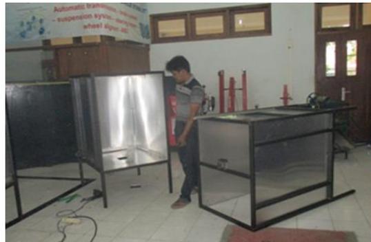
**Gambar 4.** Proses pembuatan dinding oven dan heat exchanger
