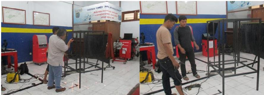
**Gambar 3.** Proses pembuatan kerangka oven
