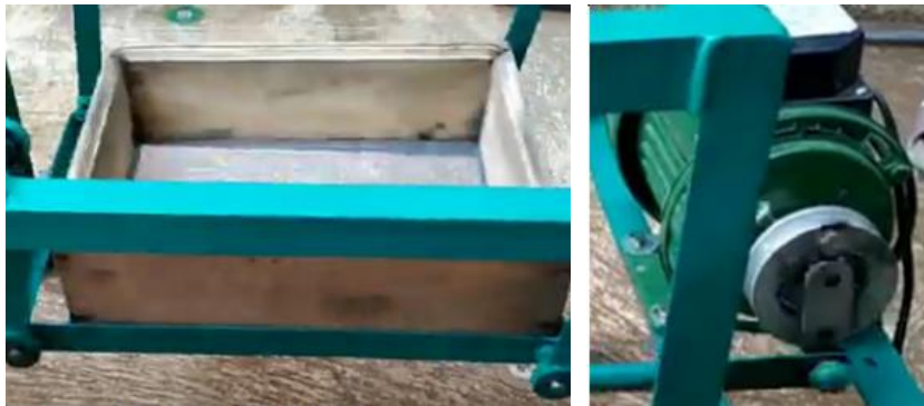
Gambar 6. Kontainer ayakan berikut lengan engkol dan dinamo penggeraknya
