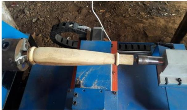
Gambar 4. Hasil bubut kayu dari mesin bubut CNC
