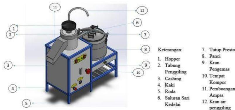
Gambar 3. Rancangan mesin pengolah susu kedelai
