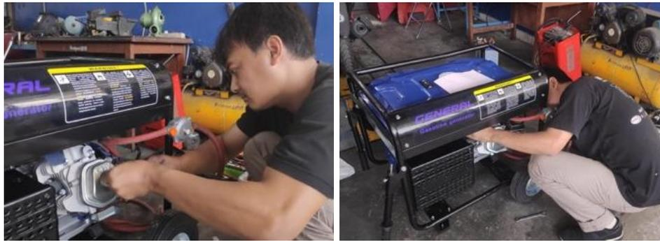
Gambar 5. Proses konversi mesin penggerak berbahan bakar bensin menjadi gas
