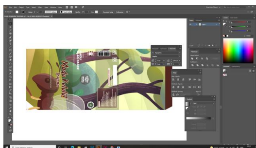
Gambar 5 . Pembuatan pola potong dengan menggunakan software Adobe Illustrator
