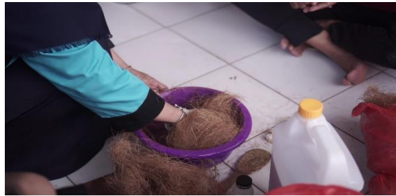
Gambar 2. Proses pencampuran coco fiber dengan resin
