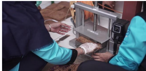
Gambar 3. Proses pencetakan papan berserat
