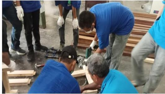
Gambar 12. Proses pengeboran untuk pemasangan dowel
