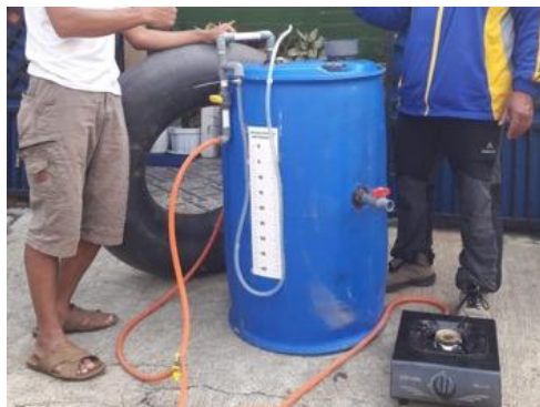
Gambar 6. Satu set biogas portabel beserta kompor
