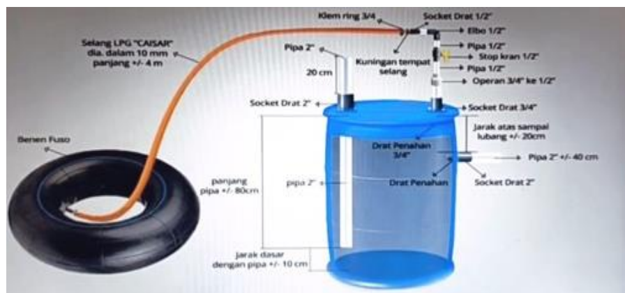
Gambar 4. Desain biodigester portabel
