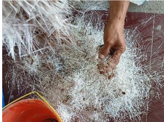
Gambar 4. Proses pencampuran fiberglass dan serat sabut kelapa sawit
