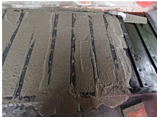
Gambar 5. Proses pencetakan plat GRC
