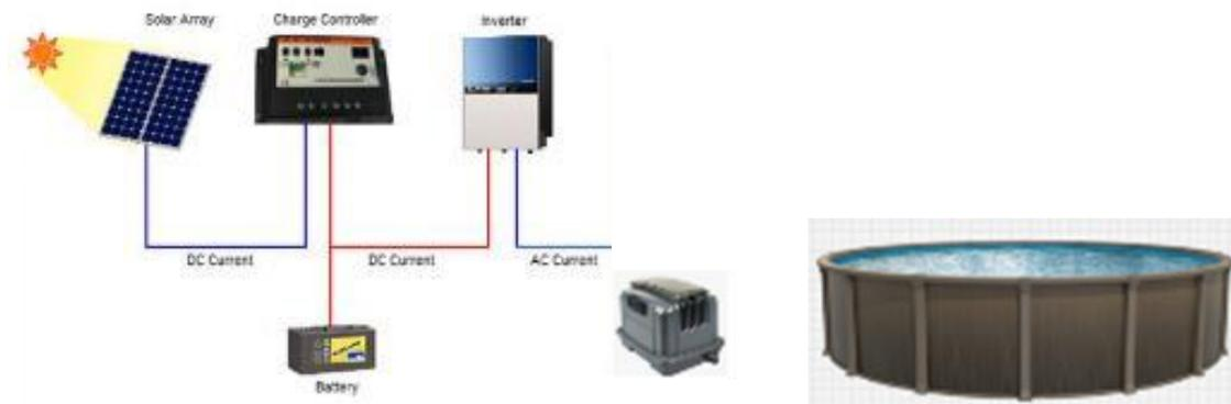
Gambar 3. Desain skematik PLTS untuk kolam lele *bioflok*
