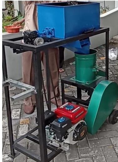
Gambar 2. Mesin pelet pakan ikan dua fungsi
