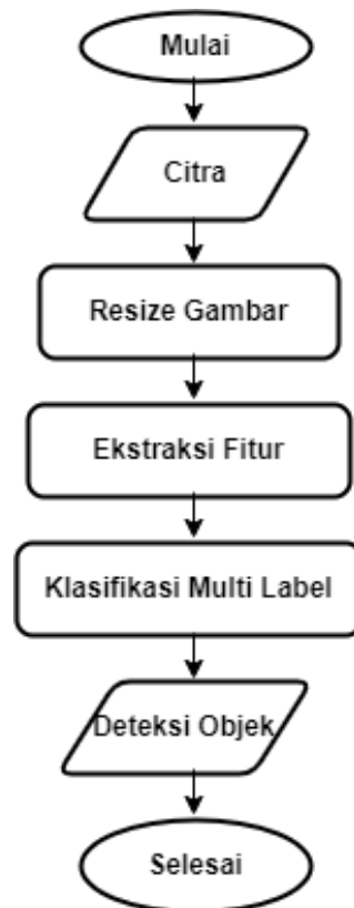
Gambar 3. Tahapan pada Arsitektur YOLOv4
