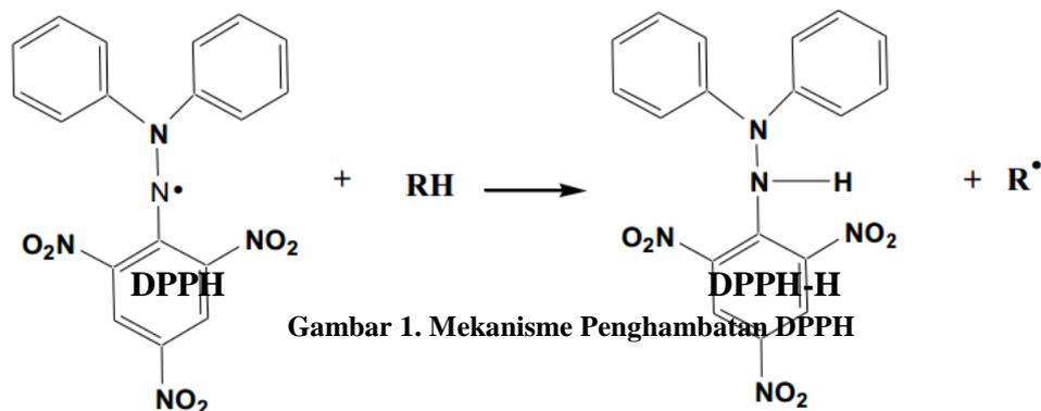
**Gambar 1. Mekanisme Penghambatan DPPH**
