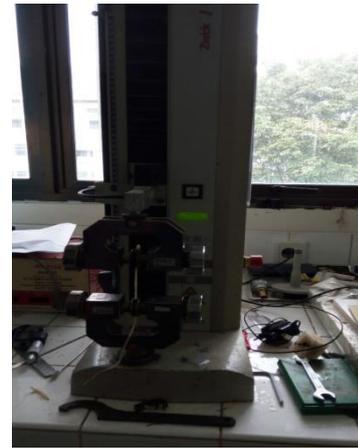
**Gambar 5.** Proses Pengujian Elongasi
