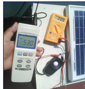
Gambar 2. Pengujian dilakukan dengan alat ukur kuat cahaya Fluxmeter (Lightmeter) Lutron LX-1108 dan Multimeter Digital . Variabel yang diukur adalah kuat cahaya ( lux ), tegangan ( volt ) dan arus ( amper ).
