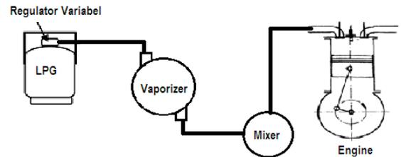
**Gambar 1.** Skema Instalasi mesin dengan bahan bakar LPG
